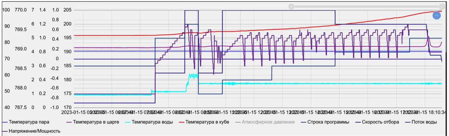
За счет добавления на график дополнительных данных на примере видно, как работал регулятор напряжения в режиме предзахлеб.
