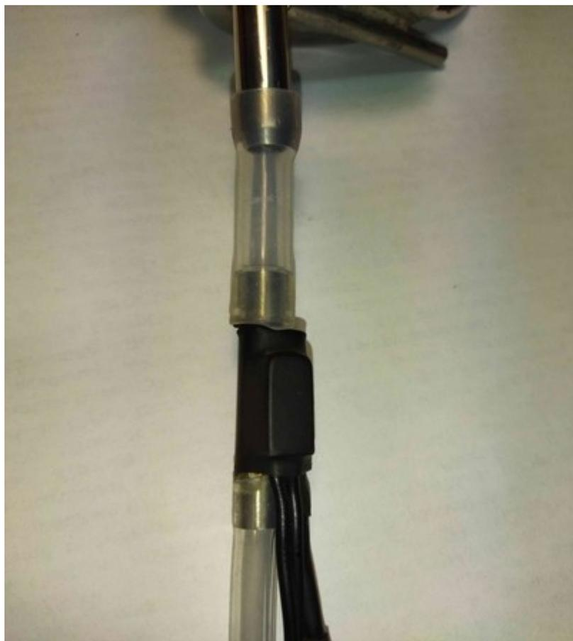
Можно не использовать медную трубку вообще, а прижать датчик без гильзы непосредственно к нержавеющей трубке, но придется озаботиться герметизацией датчика, к тому же площадь теплового контакта для KSD9700 уменьшится.
